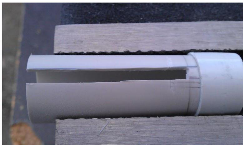
Photo 11 : Découpe transversale dans le tube de diamètre 25mm
