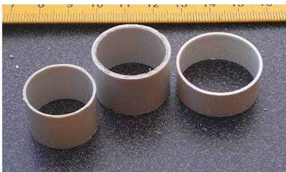
Photo 6 : les 3 morceaux de pvc utilisés pour adapter l'extrémité B avec le tube
