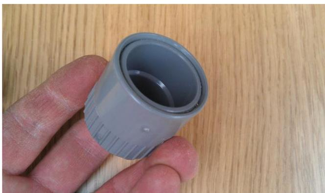
Photo 4 : Assemblage de l'extrémité après réduction du manchon
