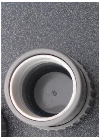
Photo 5 : Extrémité A avec réduction de manchon IRL diam 25
